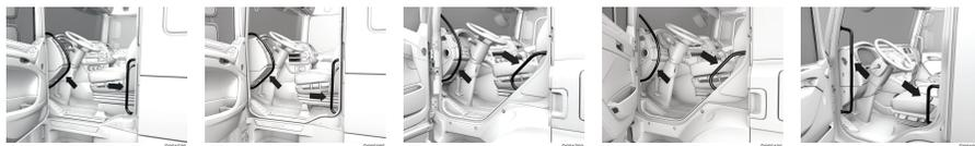
Para entrar e sair da cabine, use as alças de apoio nas colunas da porta esquerda e direita, e não o volante. Use também todos os degraus e sempre fique de frente para a cabine ao entrar ou sair.
