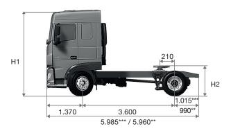
\*Condição veículo vazio. \*\*Suspensão pneumática. \*\*\*Suspensão metálica
